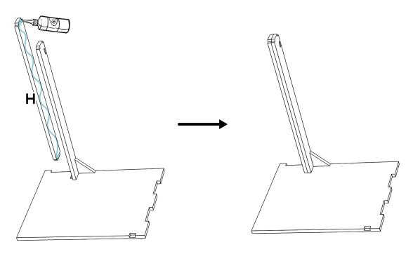
Appliquer de la colle au niveau des encoches et jonctions puis assembler la pièce **E** avec le reste du meuble.
