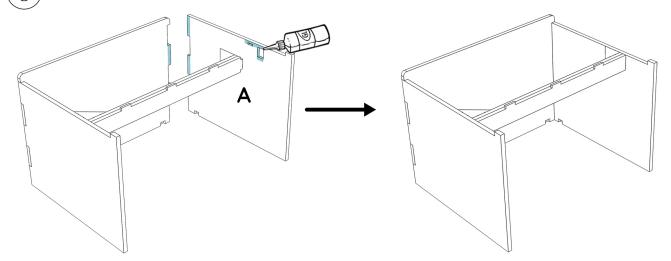
(7) Appliquer de la colle au niveau des encoches et jonctions puis assembler la pièce  $\bf c$  avec le reste du meuble.
