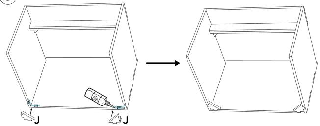
Appliquer de la colle au niveau des jonctions, puis assembler la pièce **G** avec le reste du meuble, puis la visser par l'intérieur avec 4 vis de 25 mm fines. **Attention à bien aligner cette pièce.**
