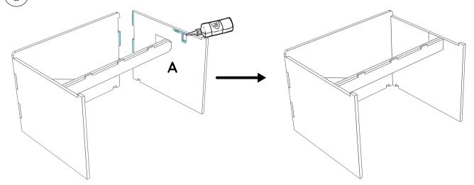
(7) Appliquer de la colle au niveau des encoches et jonctions puis assembler la pièce **c** avec le reste du meuble.
