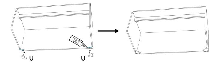
Appliquer de la colle au niveau des jonctions, puis assembler la pièce **O** avec le reste du meuble, puis la visser par l'intérieur avec 4 vis de 25 mm fines. **Attention à bien aligner cette pièce.**
