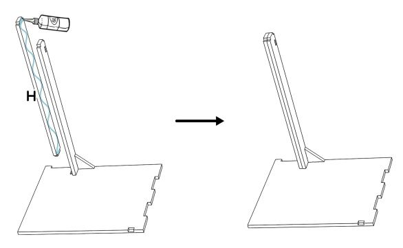
igg(4igg) Appliquer de la colle au niveau des encoches et jonctions puis assembler la pièce **E** avec le reste du meuble.
