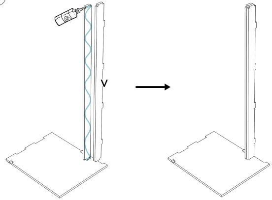
ig(4ig) Appliquer de la colle au niveau des encoches et jonctions puis assembler la pièce **S** avec le reste du meuble.
