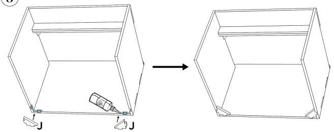
Appliquer de la colle au niveau des jonctions, puis assembler la pièce **G** avec le reste du meuble, puis la visser par l'intérieur avec 4 vis de 25 mm fines. **Attention à bien aligner cette pièce.**
