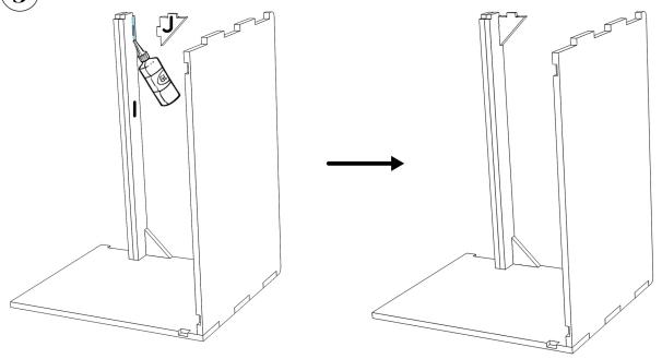
Appliquer de la colle au niveau des encoches et jonctions puis assembler la pièce **A** avec le reste du meuble.
