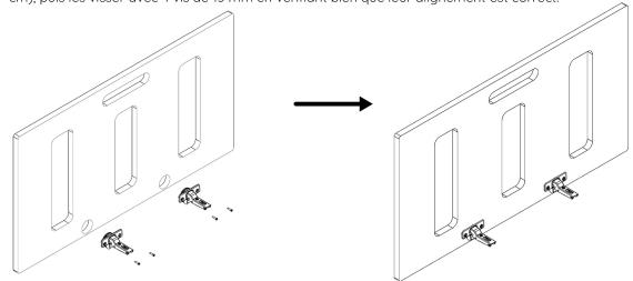
(2) Visser les embases cruciformes dans les avant-trous avec de 4 vis de 15 mm.
