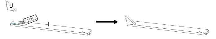
(2) Appliquer de la colle au niveau des encoches et jonctions puis assembler la pièce **B** avec l'ensemble I/J.
