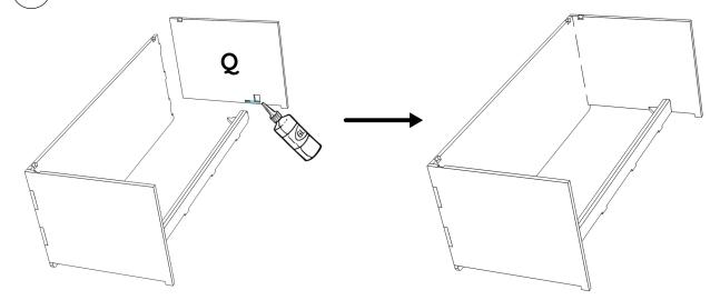
(7) Appliquer de la colle au niveau des encoches et jonctions puis assembler la pièce  $\kappa$  avec le reste du meuble.
